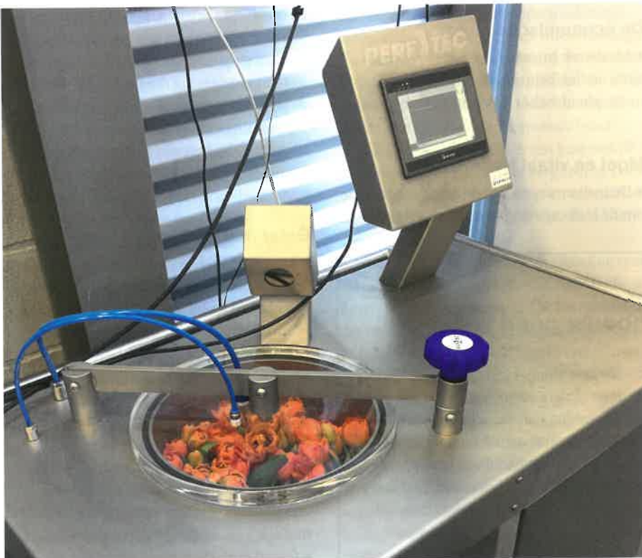
Met de respirometer wordt de ademhaling van de bloemen gemeten. Dus hoeveel zuurstof ze verbruiken en CO 2 ze uitstoten.
